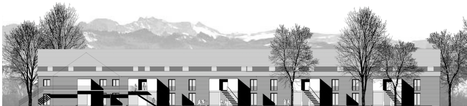
Ansicht Nordseite mit vorgefertigten Windfängen
